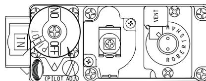
BOUCHON DE CONTRÔLE DE GAZ EST MONTRÉ DANS LA POSITION "FERMÉ"
